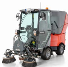
Übers ganze Jahr: mit hydraulisch angetriebener 2-Besenkehrereinheit und patentiertem Umlaufwassersystem.
