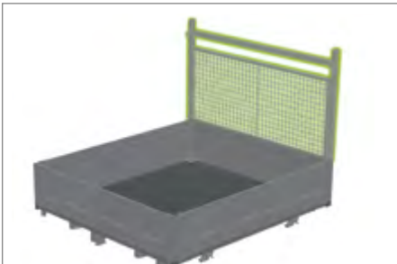
Aufprallschutzgitter Transport von Langgut & Schutz der Fahrgastzelle und des Heckfensters. Höhe ausgehend von der Oberkante der Pritschenwand: 940mm
