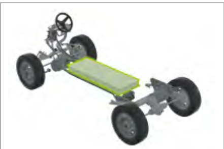
Reichweitenpaket Die große 33 kWh Batterie erhöht die Reichweite auf bis zu 200 km (NEFZ)
