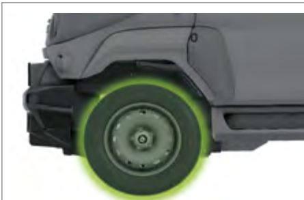
Reifen & Räder Erhältlich in folgenden Ausführungen: Satz Sommerkomplettträder 185/75R16C, Felge: 6Jx16 Stahlfelge Satz Winterkomplettträder 185/75R16C, Felge: 6Jx16 Stahlfelge, Schneekettentauglich Satz Geländekomplettträder 185/75R16C, Felge: 6Jx16 Stahlfelge Satz Ganzjahreskomplettträder 185/75R16C, Felge: 6Jx16 Stahlfelge, Schneekettentauglich
