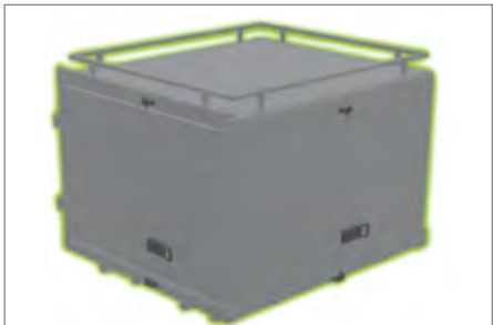
Koffer Viel Platz, Schutz vor Witterung. Beifahrerseite: Türe schwenkbar um 180°; Um 270° schwenkbare Hintertüren (fixierbar); Rehling optional. Ladehöhe: 924mm, Außenmaße (LxBxH): 1899mm x 1652mm x 1322 mm; Innenmaße (LxBxH): 1787 mm x 1535 mm x 1105 mm
