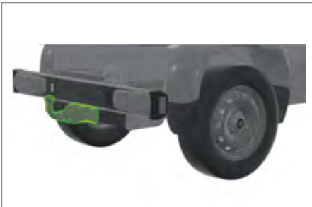
Abnehmbare Anhängerkupplung zusätzliche Transportmöglichkeit: gebremst 1.000kg / ungebremst 750 kg / 70 kg Stützlast
