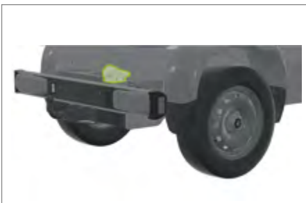
Externe Steckdose Versorgen Sie Ihre 230 V Geräte mit bis zu 3 kW Dauerleistung (Fahrzeug als Energiequelle)
