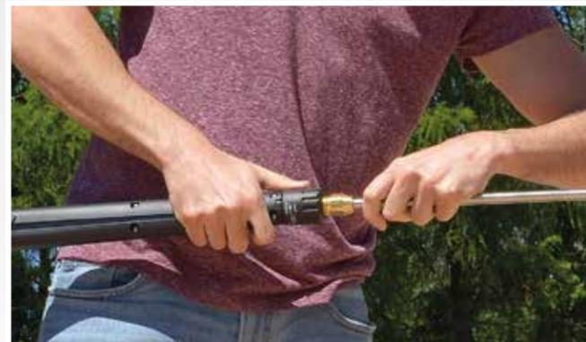
Abb. Ausführung mit Verschraubung
