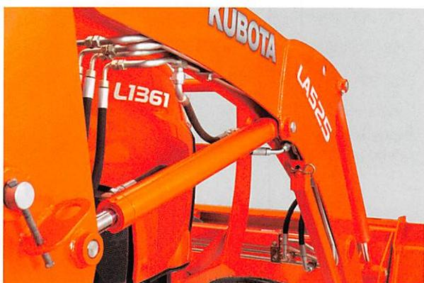
**Geschützt verlegte Hydraulikleitungen**
