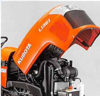
**Gute Wartungszugänglichkeit/Motorhaube öffnet durch Gasdruckfeder**
