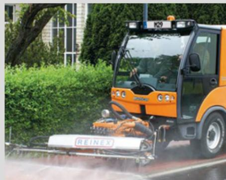
Leistung unter Hochdruck: in Kombination mit einem Schwemmbalken für die intensive Flächenreinigung.
