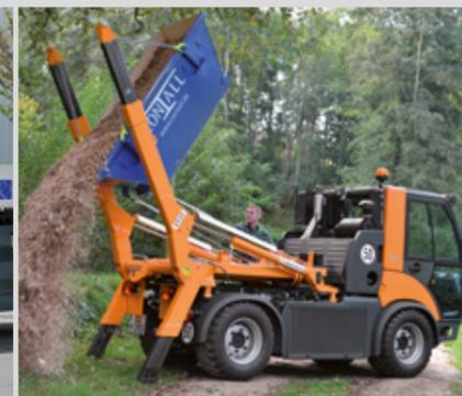
Absetzkippsysteme ermöglichen den Wechselbetrieb mit verschiedenen Transportbehältern – auch zur Hochentleerung.
