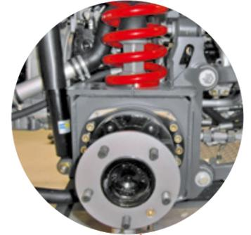
Sicheres Fahrverhalten auch bei hoher Zuladung: durch Schraubenfedern, Stoßdämpfer und Stabilisatoren.
