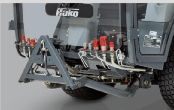
Schnell, einfach, werkzeuglos: Dank Schnellwechselsystem ist der Citymaster im Handumdrehen für den nächsten Einsatz gerüstet.
