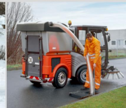
Auch schwer zugängliche Stellen gut erreichen: mit dem flexiblen Handsaugschlauch für Arbeiten rund um die Maschine.
